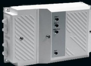
Zentrale, für Gefahrenmelder, zum Betrieb von max. 16 St. Rauchmelder CHOR-E bzw. Hitzemelder HA05. 2 Meldelinien (max. 8 Melder pro Linie, Parallelanschluss) Abschaltung für PA Anlagen. Stromversorgung: 230V, 50 Hz. Spannung für Meldelinien: 9V DC max. 100mA. Spannung für Zusatzgeräte bzw. Sirene: 12V DC, max. 400mA. Inkl. Wechsler-Relais: max. 1 A / 60V DC und Notstromakku: 12V / 280mAh. Abmessungen: 145 x 98 x 48mm.
