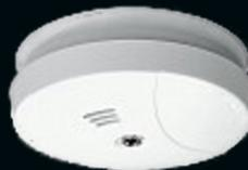
Rauchmelder, zum Anschluss an die Zentrale RZ 03, foto-elektronisch. 9 Volt Versorgung von der Zentrale. Mit lautem 85 dB(A) Warnton, Kontrolllampe und Prüftaste. Im Alarmfall ertönt das Warnsignal aus allen CHOR-E Meldern. Parallelanschluss an RZ 03 über abgeschirmtes Kabel mit mind. 2 Adern. Inkl. separatem Anschlusssockel für bequeme Montage. Abmessungen: Ø 110 x 40 mm.
