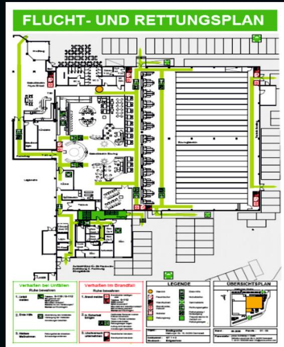
Zur Kennzeichnung von Fluchtwegen im Bowlingcenter nach DIN EN 60589-1, DIN EN 60589-2-22 und DIN 4844 sind Rettungszeichenleuchten erforderlich. Die Notbeleuchtung ist ein wichtiger Bestandteil des Sicherheitskonzeptes eines Gebäudes und muss bei jeder Planung Berücksichtigung finden. Rettungszeichen- und Sicherheitsleuchten dienen in Gefahrensituationen dem risikolosen Verlassen von Gebäuden oder Anlagen.
